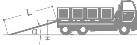
ANWENDUNGSBEISPIEL: Es wird angenommen, dass ein Höhenunterschied (H) von 1.200 mm überwunden werden muss. Bei Anwendung oben angeführter Formel erhält man:
