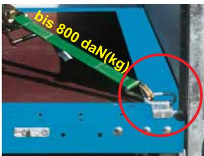
**Optimale Raumaussnutzung und Verzurrmöglichkeit.** Auch beim Palettentransport ist die Ladungssicherung jeder einzelnen Palette möglich. **Es geht kein Laderaum verloren** wie bei versenkten Anbinde-
