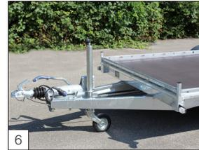
**Serienausstattung:** die gebremsten Modelle sind mit einer geschraubten V-Deichsel und einem klappbaren Stützrad ausgestattet. Die ungebremsten Modelle haben eine geschraubte Rohrdeichsel und ein leichtes Stützrad.
