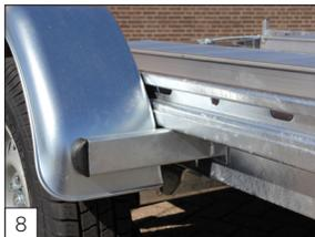
**Serienausstattung:** 4 Kotflügelstützen zum Anbringen der Kotflügel.
