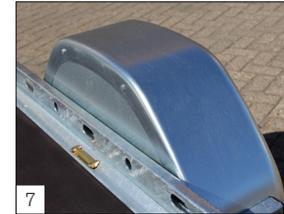
**Serienausstattung:** die Kotflügel sind an der Innenseite geschlossen. Ausgestattet mit TÜV-geprüften Verzurrbügeln, integriert in den Seitenrahmen, jeweils mit einer Kapazität von 1000 daN.
