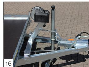
**Option:** Winde mit Stütze an der Vorderseite (nur bei gebremsten Ausführungen möglich).
