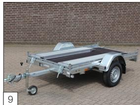
**Serienausstattung:** Indigo L-1 ist als ungebremste Ausführung in 750 kg oder gebremst in 1350, 1500 oder 1800 kg erhältlich.
