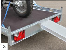
**Serienausstattung:** U-Profil an der Rückseite zum Anlegen der Auffahrschiene(n).
