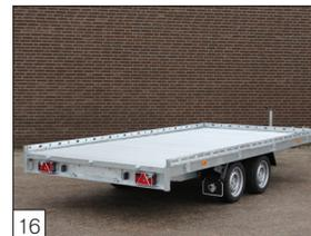
**Option:** Boden aus Aluminiumprofilen und Abschirmung der Heckleuchte montiert.
