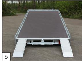
**Option:** Aluminium-Auffahrstienen in verschiedenen Längen möglich anstelle einer durchgehenden Heckklappe.
