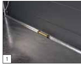
**Serienausstattung:** in den Seitenrahmen integrierte Verzurrbügel mit einer Kapazität von 1000 daN.
