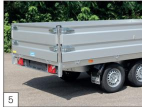
**Option:** abnehmbare Aluminium-Aufsatzbordwände 30 oder 40 cm hoch.
