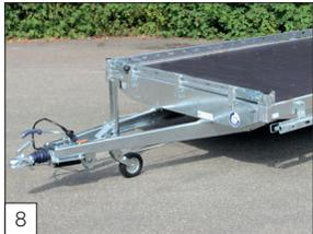
**Option:** klappbare oder feste Combi Protect Rail anstelle von Bordwänden (bei klappbarer Combi Protect Rail wird das Anhänger-Innenmaß 5 cm kleiner).
