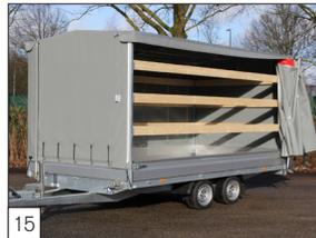
**Option:** Links und rechts eine Schiebeplane montiert (ab 450 cm inkl. Mittelposten).
