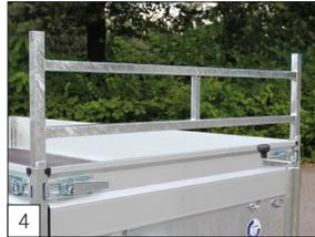
**Option:** Abnehmbares Frontgitter montiert und gesichert in den Eckrungen.
