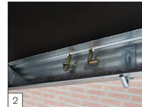
**Option:** Schraubbarer Anbindehaken an der Innenseite des Außenrahmens zum einfachen Befestigen von z.B. einem Ladungsnetz.
