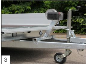
**Option:** Winde mit Windenstütze an der Vorderseite montiert (nur möglich bei Modellen mit Bordwänden in Standardhöhe 30 cm).
