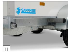
**Serienausstattung:** Kotflügelträger zur Befestigung von Kotflügeln montiert.
