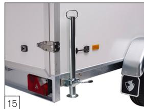
**Option:** Schiebstützen montiert.
