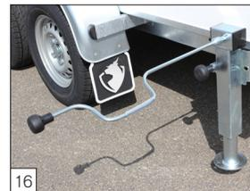
**Option:** solide Kurbelstützen (drehbar und einstellbar) einschließlich Kurbel.
