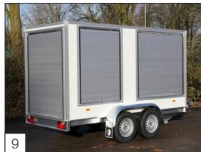
**Option:** Aluminium-Aufroll-Rolladen auf der Rückseite und Schiebeläden an den Seiten.
