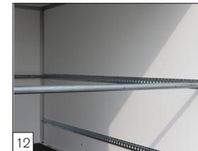
**Option:** Ladungssicherungssystem in dem geschlossenen Aufbau mit Sperrstange und Spanngurt.
