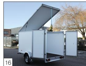
**Option:** aufklappbarer Deckel an der Vorderseite (möglich bis zu einer Größe von max. 300 x 150 x 180 cm).
